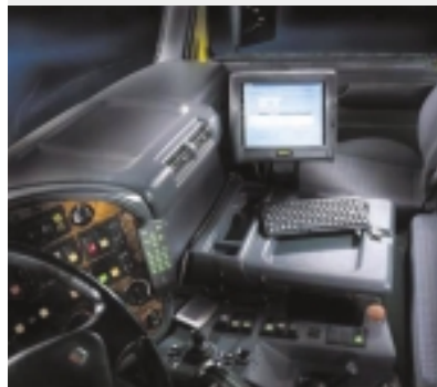
PC im LKW: integriertes GPS, Mobilkommunikation, E-Mail, Internet und PC-Software
